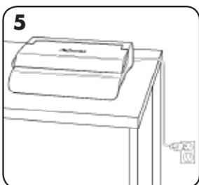
5. Das Gerät an einer gut zu erreichbaren Steckdose anschließen. Die Hauptstromversorgung einschalten.
