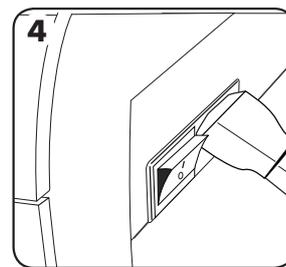
4. Die Leitung an dem Gerät anschließen (die Buchse befindet sich hinten am Gerät).
