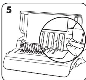
5. Restblätter teststanzen, um die Einstellung der Seitenführung zu prüfen.
