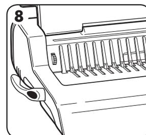
8. Sicherstellen, dass der Kammöffnungshebel nach hinten gedrückt ist.
