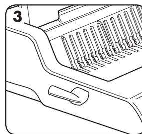
3. Den Plastikkamm in den Öffnungsmechanismus einsetzen.
